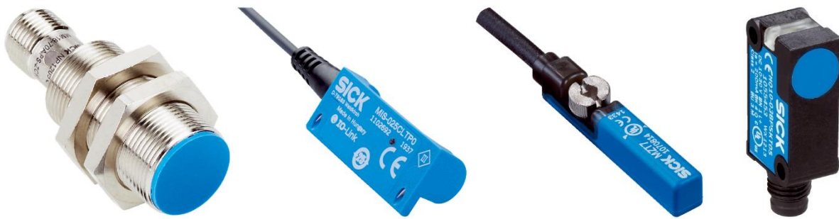
Obr. 11 – Průmyslová provedení magnetického detektoru, po řadě zleva doprava: ve válcovém pouzdře s vnějším závitem, v dveřním provedení, v provedení pro pneumatické válce s T-drážkou a v pouzdře ve tvaru kvádru, zdroj (Sick, 2023c)
