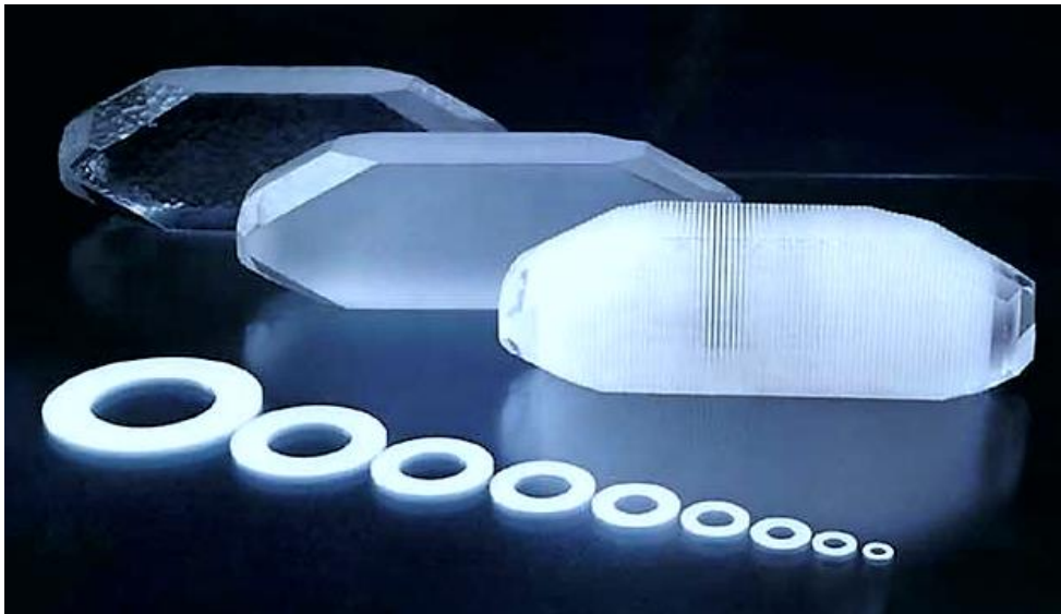
Obr. 3 – Křemenný krystal \text{SiO}_2 a realizované kruhové výbrusy různé velikosti, zdroj (Kistler Group, 2023)
