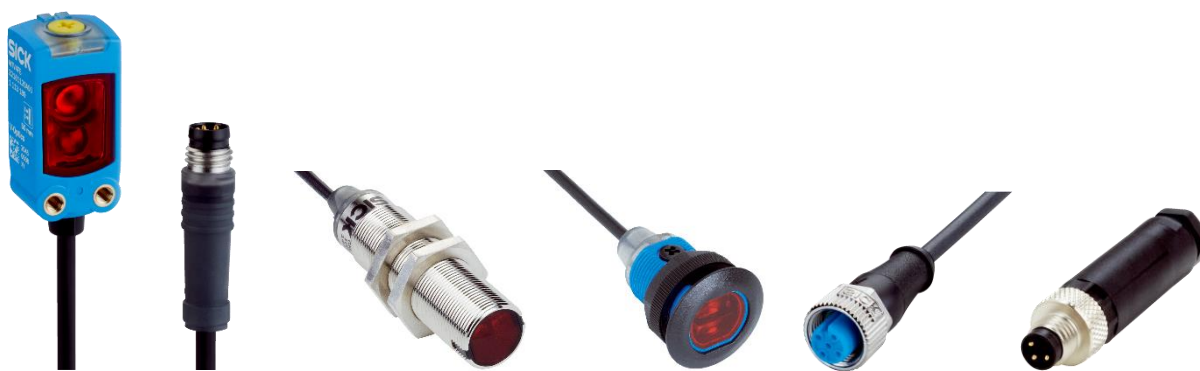
Obr. 24 – Různá průmyslová provedení retroreflektivních optických senzorů, postupně zleva doprava: v pouzdře ve tvaru kvádrů s kabelem (řada W), ve válcovém kovovém a plastovém pouzdře s vnějším závitem (řady GR a GRS), kabel s konektorem a konektor pro připojení k měřicímu systému nebo adaptéru, zdroj (Sick 2023d)
