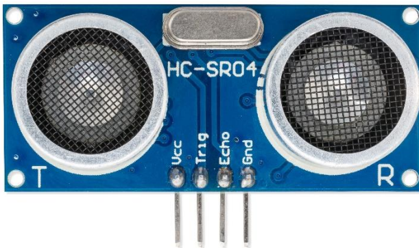
Obr. 5 – Levný ultrazvukový snímač vzdálenosti Kitronik HC-SR04, zdroj (Kitronik, 2023)
